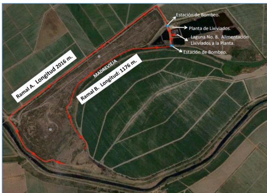
Figura 4. Red de captación de lixiviados.
