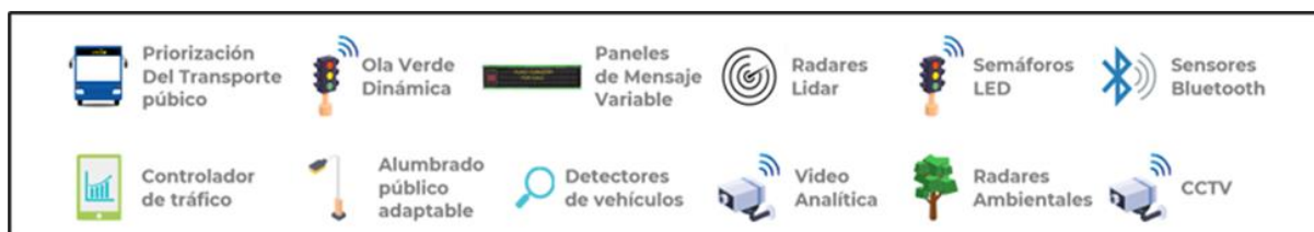
Figura 13. Componentes del Sistema de Semaforización Inteligente (SSI) y su solución a nivel de intersección. Fuente. Elaboración propia.
