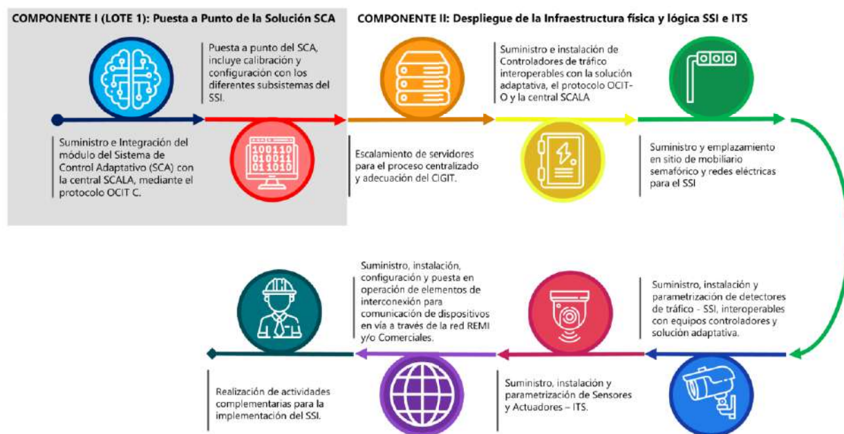
Figura 44. Componentes para la implementación del Sistema de Semaforización Inteligente en Santiago de Cali. Fuente. Elaboración propia.
